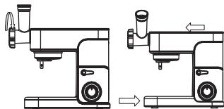
Um den Fleischwolf abzunehmen, drehen Sie das Gehäuse sodass der Pfeil am Kreis ausgerichtet ist und dann entfernen.
