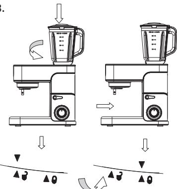
1. Platzieren Sie den Behälter im Motorgehäuse. sodass der Pfeil am Kreis ausgerichtet ist. Drehen Sie ihn im Uhrzeigersinn, bis die 2 Pfeile angezeigt zusammen ausgerichtet werden.
