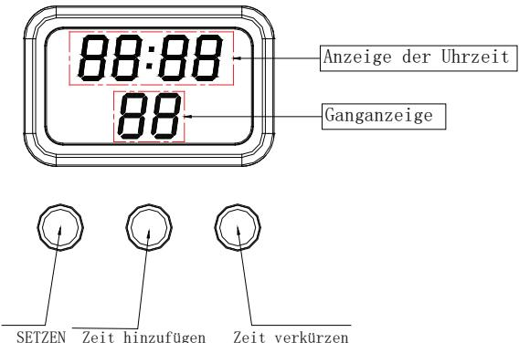
**EINSTELLEN:** Drücken Sie leicht auf die Funktionstaste für die Zeiteinstellung, um die Einstelloberfläche für die Rührzeit aufzurufen. Zeit hinzufügen/verringern: Nachdem Sie die Schnittstelle zur Einstellung der Rührzeit aufgerufen haben, drücken Sie leicht die Additions-/Subtraktionstaste, um die Rührzeit zu addieren oder zu subtrahieren.
